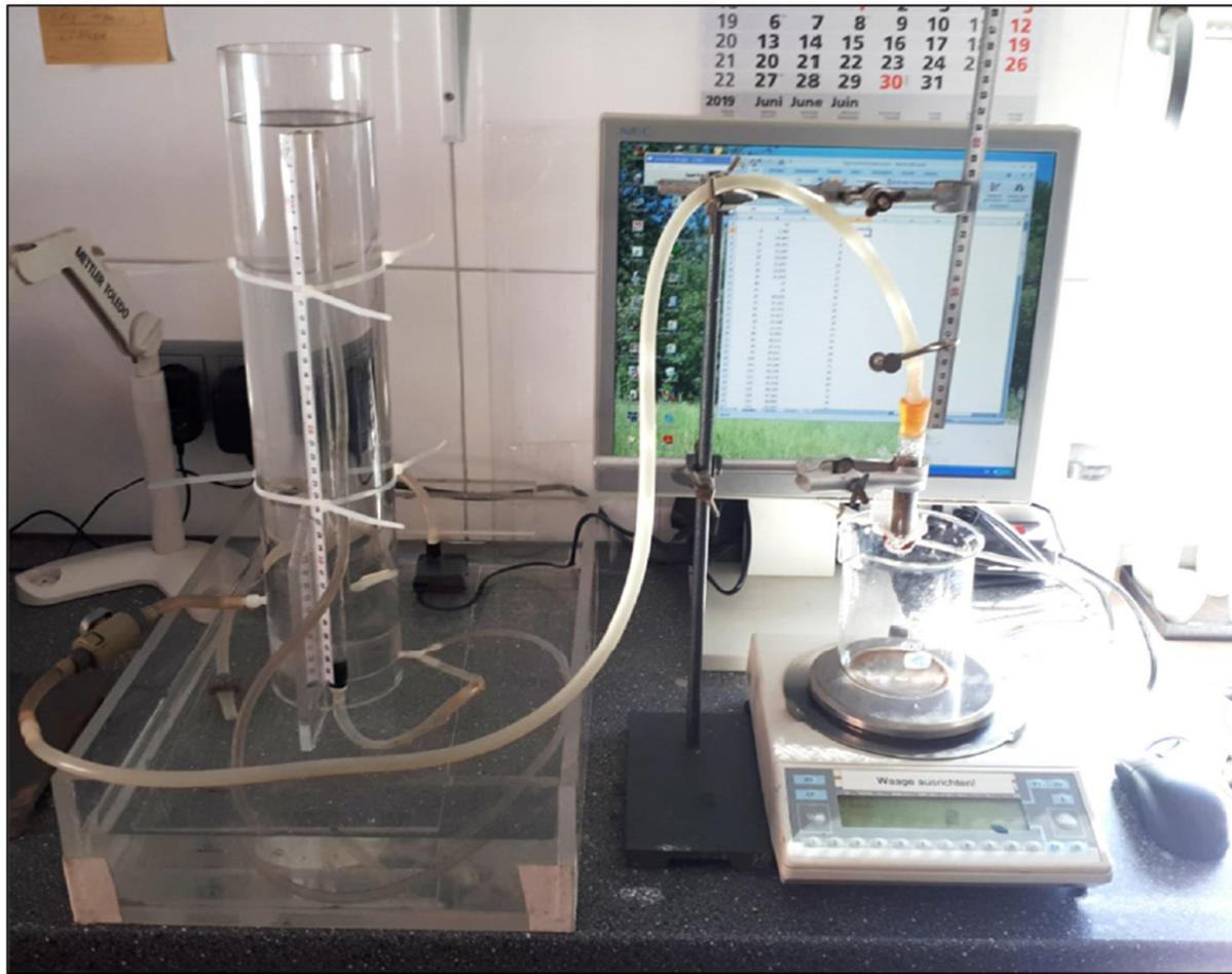
**Abb. 5.1:** Perkolationsanlage zur Bestimmung der Aggregatstabilität (Foto: O. Wegener)
