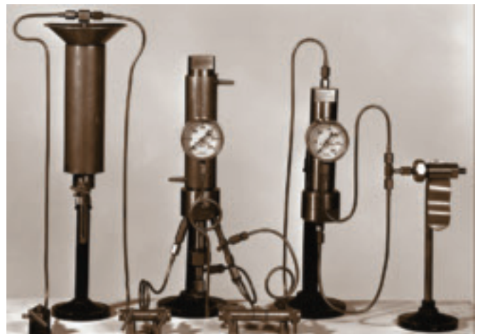
Abb. 24: Die Laborapparatur, mit der Haber 1908 erstmals Ammoniak erzeugte.
